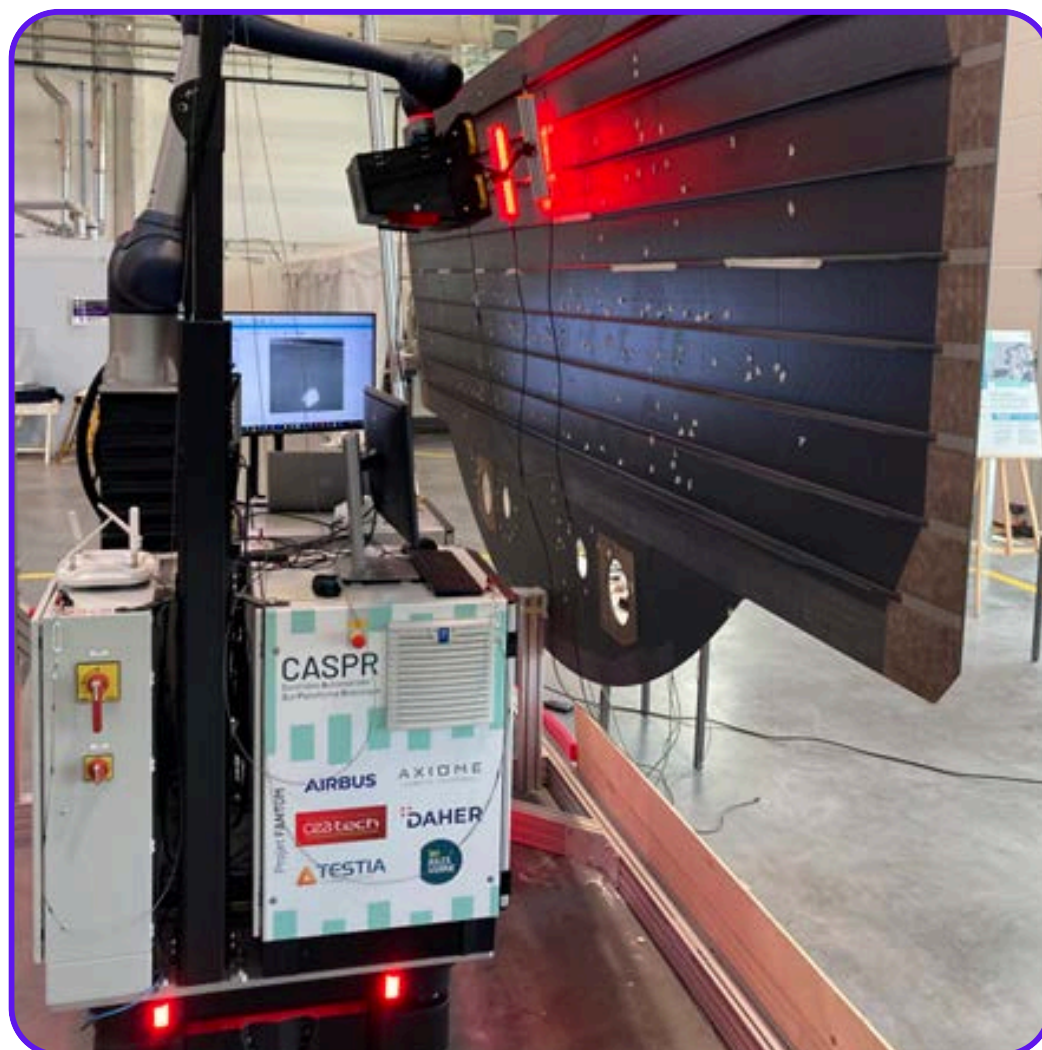
Contrôle vision automatisé de panneaux center wingbox (aéronautique)
