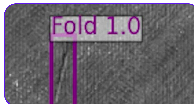
Détection automatique de rayures, plissures et écaillages sur pièces composites
