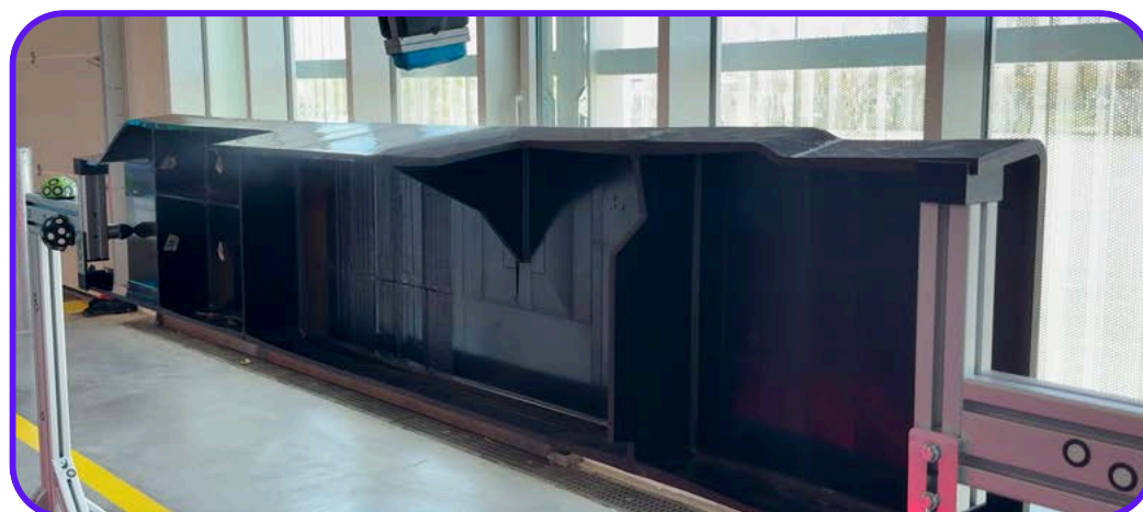
Contrôle ultrasonore automatisé d'un longeron (aéronautique)
