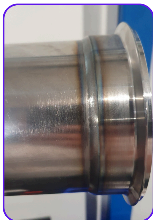
Développement de paramètres TIG pour le soudage bride/tube faible épaisseur
