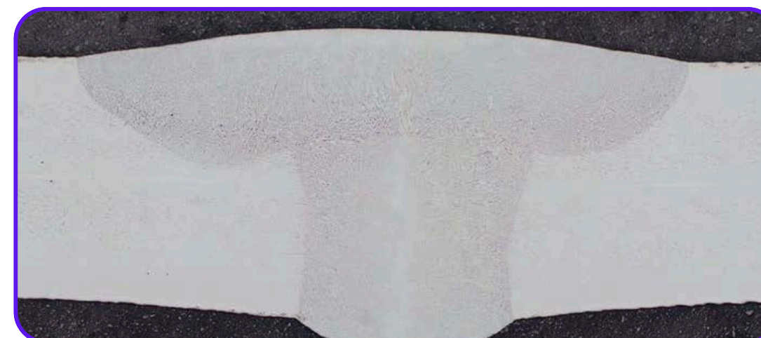
Soudage TIG fine épaisseur sur acier inox
