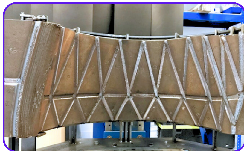
Assemblage automatisé par soudage d'un outillage complexe en INVAR – Dimension 1000x 1000 x 480 mm
