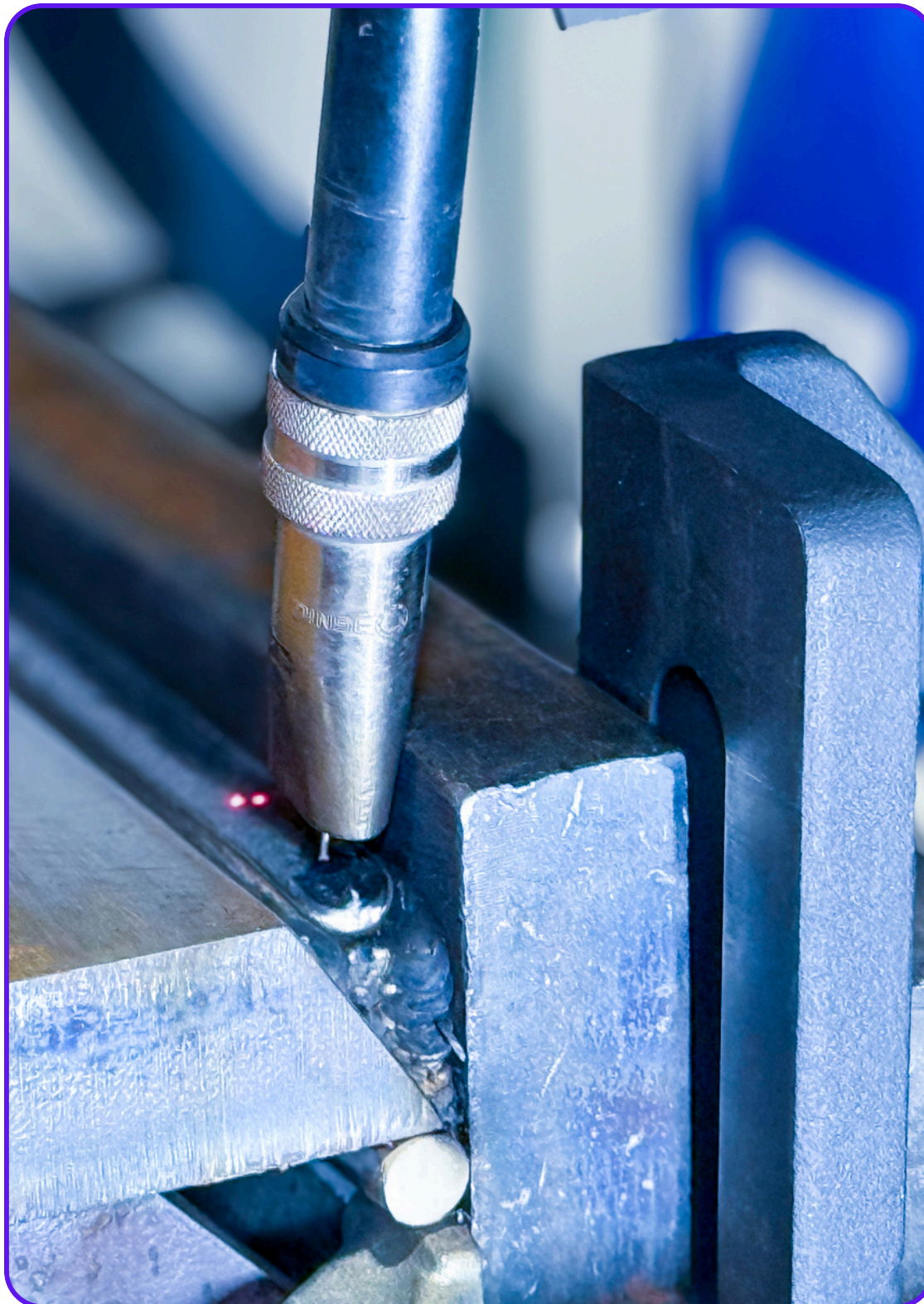
Optimisation de paramètres MAG pour assemblage acier S355 forte épaisseur
