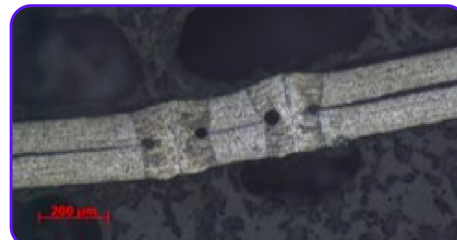
Caractérisation de la porosité dans un cordon de soudure
