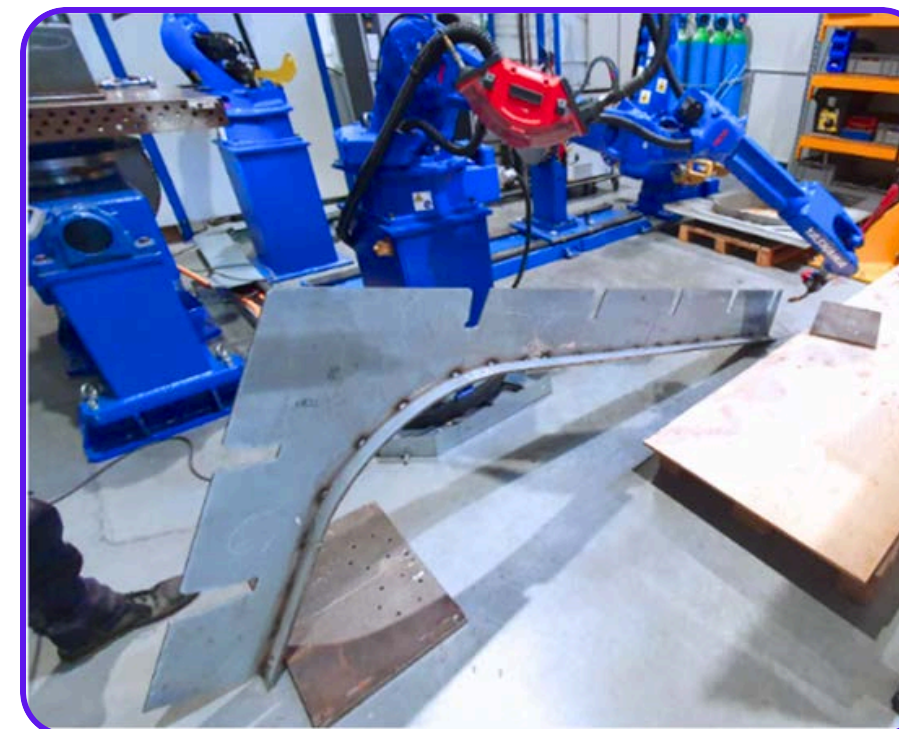
Soudage MAG en angle multi-positions pour le secteur naval
