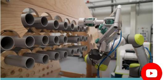
AUTOMATED PRESSURE TUBE EXTRACTION FOR THE NUCLEAR REACTOR OF THE BRENNILIS POWER PLANT
