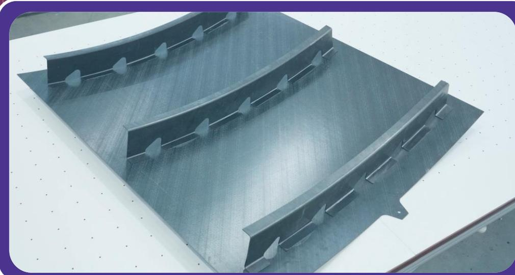
Pièce réalisée avec le moyen de soudage par conduction
