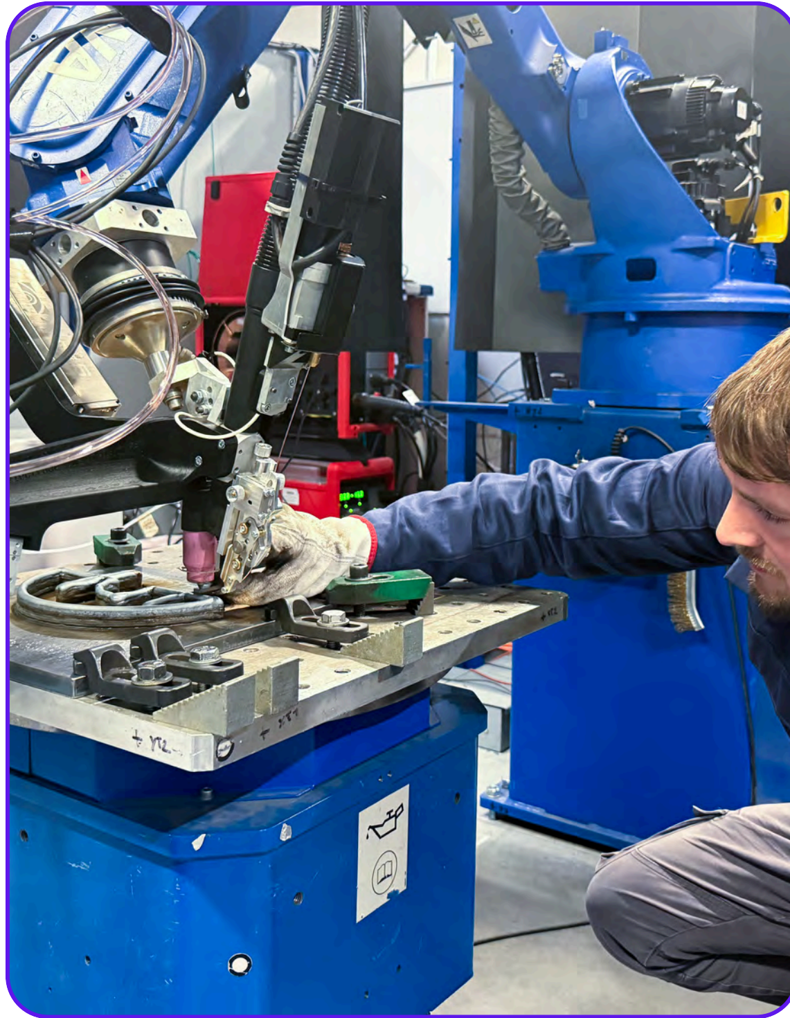
Fabrication d'un démonstrateur en acier par le procédé TIG avec suivi du bain par caméra
