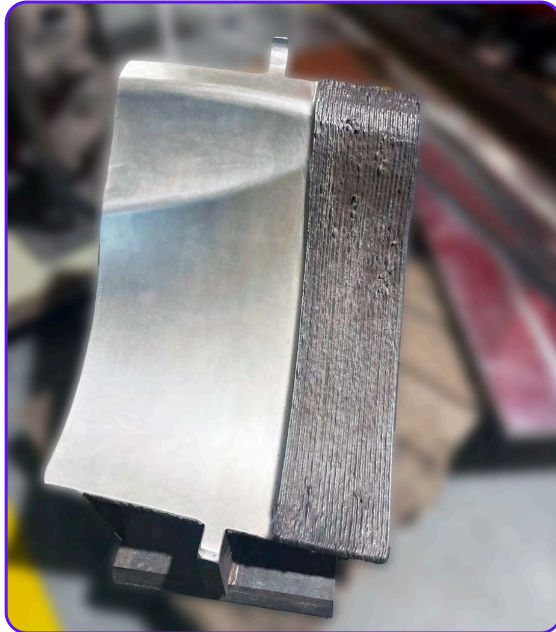
Outillage pour application composite en Invar réalisé en fabrication additive WAAM Dimensions du moule : 1000 x 450 x 450 mm
