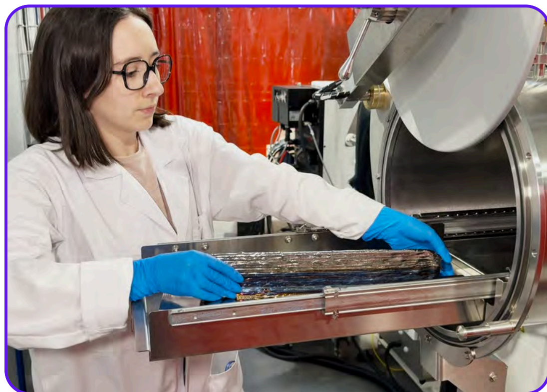
Développement de systèmes d'inertages et contrôle du taux d'oxygène adapté au WAAM
